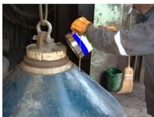
Relleno epóxico 100% sólidos, de baja viscosidad, especialmente desarrollado para usarse como material de respaldo en las placas de desgaste, como en los forros de las chancadoras giratorias cónicas, molinos y en otras múltiples aplicaciones que realizan el papel de relleno.
